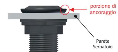
L'espansione della guarnizione realizza sia la tenuta dalla parte interna del serbatoio che un vero e proprio ancoraggio del raccordo alla parete.
